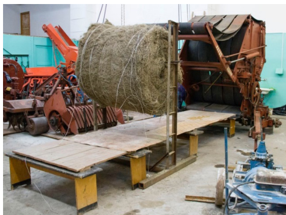
Рис. 1. Общий вид стационарного смотчика рулонов на базе пресс-подборщика ПРП-1,6
